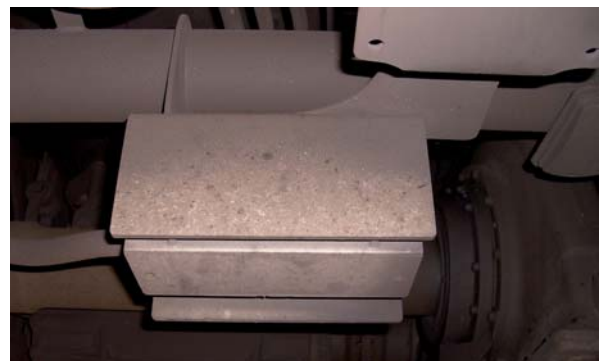
LZB-Antenne mit Schutzblech am ICE (Quelle: DB AG)
