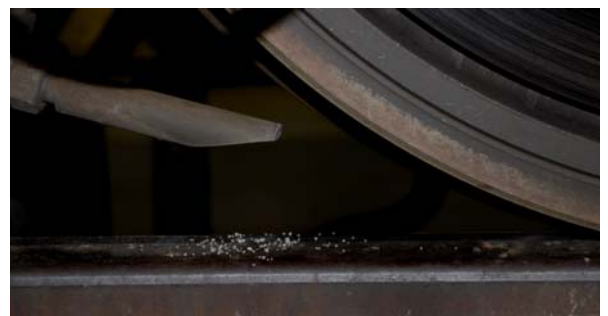
Auslauf der Besandungsanlage eines ICEs
