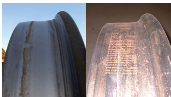
Rad mit Verschleißspuren (links) und neues Rad (rechts)
