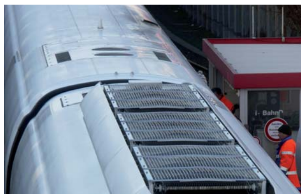
Fahrtwindgekühlte Bremswiderstände in Dachanordnung auf ICE-TD BR 605, Foto: DB AG
