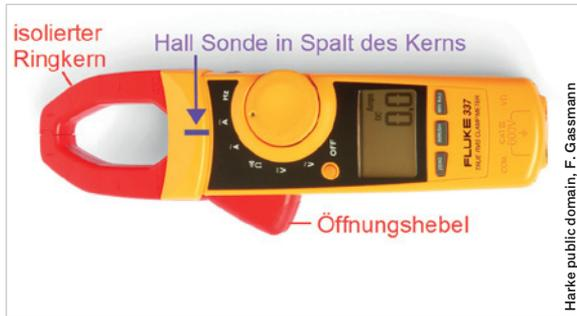
Abb. 4: Stromzange zur berührungslosen Messung der Stromstärke in einem Draht.
