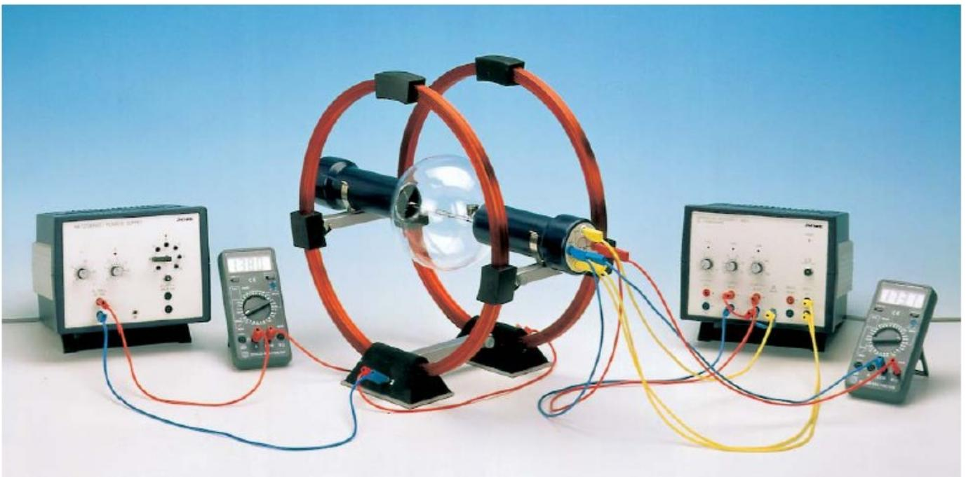
Abb. 1: Versuchsaufbau zur Bestimmung der spezifischen Ladung des Elektrons.
