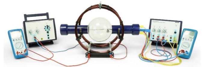
Abb. 3 Versuchsanordnung zur Bestimmung von e/m mit dem Fadenstrahlrohr P2510200.
